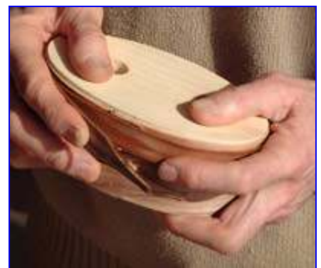
Photo 11. Lid Bent to Box
